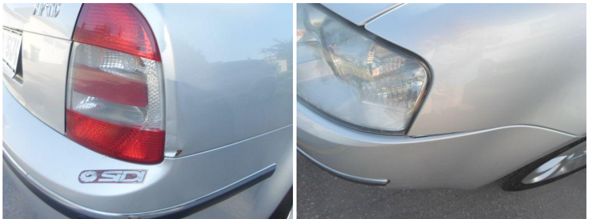
Obr.5 – Poškození pravého zadního blatníku a nelícující obal předního nárazníku na levé straně.
