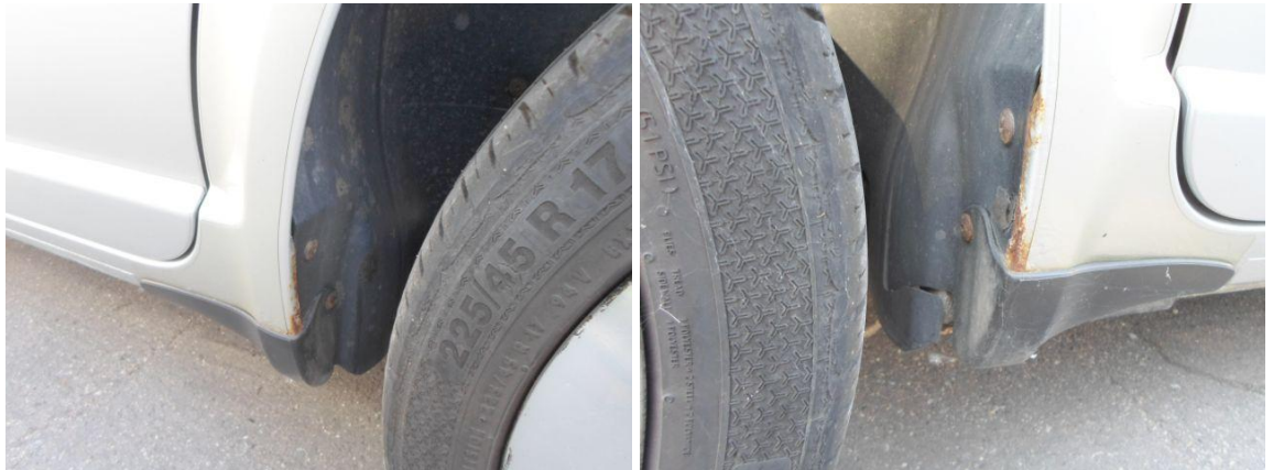
Obr.4 – Koroze zadních blatníků.
