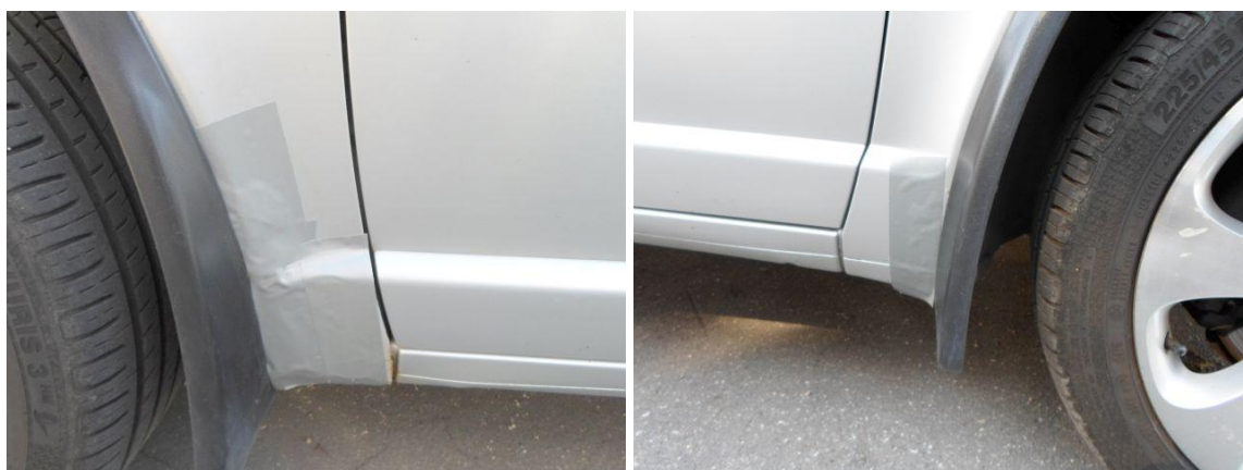
Obr.3 – Pokročilá koroze předních blatníků – přelepeno lepicí páskou.
