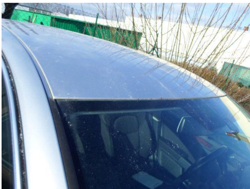
Obr.3 – Koroze vyskytující se na přední hraně střechy.
