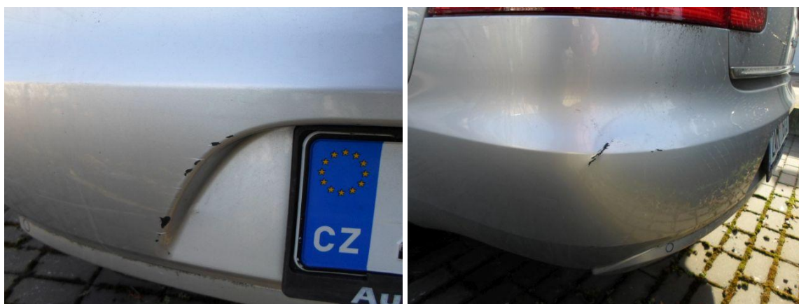
Obr.6 – Poškození plastového obalu zadního nárazníku.
