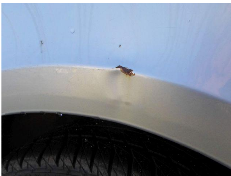
Obr.4 – Lokální deformace lemu levého zadního blatníku, s hloubkovým korozním napadením.
