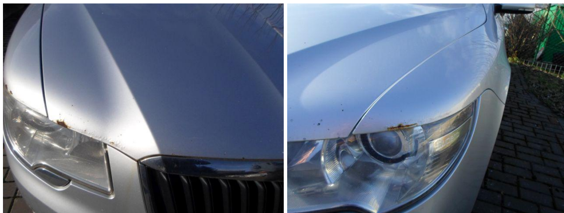
Obr.2 – Pokročilá koroze víka motorového prostoru a přední části obou předních blatníků.
